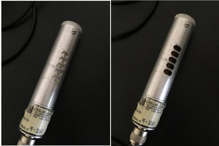
Figure 21 : Radiamètre (Ludlum 44-38) avec fenêtre bêta, en position fermée et ouverte, respectivement.
