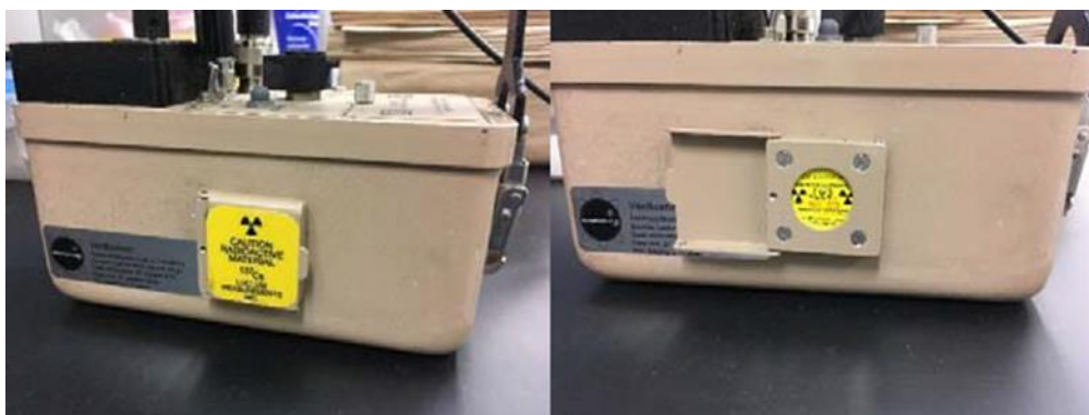
Figure 23 : Source de contrôle de Cs-137 installée sur un débitmètre Ludlum.
