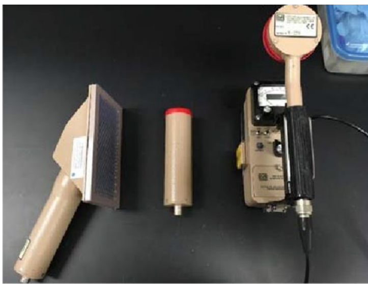
Figure 20 : Débitmètre (Ludlum 3), et trois sondes. De gauche à droite : contaminamètre à scintillateur plastique (44-116) ; contaminamètre à l'iodure de sodium (44-21) ; contaminamètre de type pancake (44-9).
