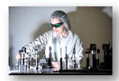
**Note:** Pour un laser en mode continu, les lunettes garantissent une protection jusqu'à une durée d'exposition de 5 s. Pour un laser à impulsions, la protection est pour un maximum de 5 s et de 50 impulsions. **Il n'y a donc aucune garantie de protection pour des temps d'exposition supérieurs à ces durées.**
