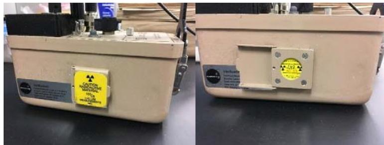
Figure 17 : Source de contrôle de Cs-137 installée sur un débitmètre Ludlum.
