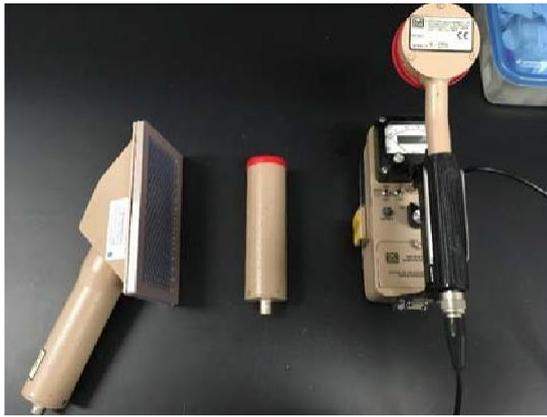
**Figure 14** : Débitmètre (Ludlum 3), et trois sondes. De gauche à droite : contaminamètre à scintillateur plastique (44-116) ; contaminamètre à l'iodure de sodium (44-21) ; contaminamètre de type pancake (44-9).
