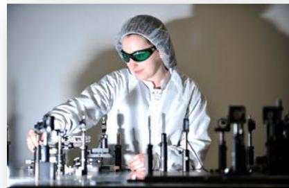
**Note :** Pour un laser en mode continu, les lunettes conformes à la norme EN-207 garantissent une protection jusqu'à une durée d'exposition de 5 s. Pour un laser à impulsions, la protection est pour un maximum de 5 s et de 50 impulsions. **Il n'y a donc aucune garantie de protection pour des temps d'exposition supérieurs à ces durées.**
