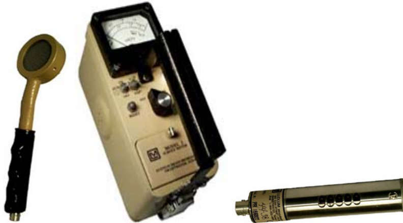
Figure 8- Radiamètre muni de deux sondes Geiger-Müller : sonde de type « pancake », à gauche, de haute sensibilité, et sonde compensée pour l'énergie, à droite, moins sensible mais dont la réponse est plus quantitative.
