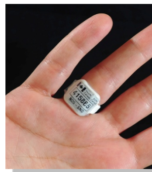
Figure 17- Dosimètre LSO et dosimètre bague DTL.
